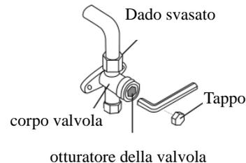
12. Utilizzando una chiave esagonale, aprire completamente sia la valvola di alta pressione che quella di bassa pressione.
