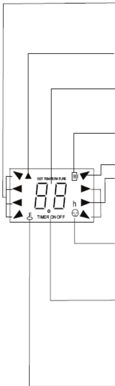
**MODE DISPLAY:** Visualizza la modalità corrente selezionata. Compresi AUTO, COOL, DRY, HEAT (modelli solo riscaldamento) e FAN.
