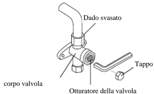
12. Utilizzando una chiave esagonale, aprire completamente sia la valvola di alta pressione che quella di bassa pressione.
