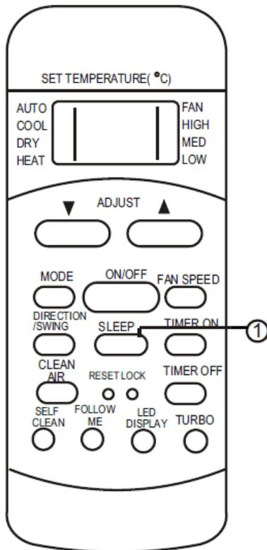
La funzione SLEEP permette all'unità di aumentare automaticamente (in raffreddamento) o diminuire (in riscaldamento) di 1°C all'ora per le prime due ore di funzionamento e di tenere costante la temperatura per le successive 5 ore, dopo di che l'unità arresterà automaticamente il funzionamento. Si può, in tal modo, mantenere una temperatura più confortevole e risparmiare energia. NOTE: la funzione SLEEP è disponibile solo nelle operazioni di raffreddamento, riscaldamento e AUTO.
