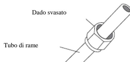
4. Rimuovere il nastro in PVC dalle estremità del tubo quando si è pronti ad eseguire la svasatura.
