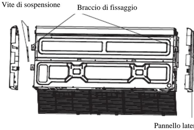
9. Montare l'unità interna sui bulloni a vite sospesi e bloccarli in posizione. Posizionare l'unità interna su un piano orizzontale verificando con una livella per prevenire perdite.
