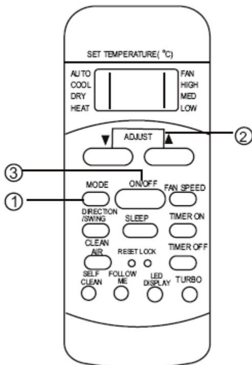
Quando si imposta il condizionatore d'aria in modo AUTO, si attiva automaticamente il raffreddamento, il riscaldamento (solo alcuni modelli) o solo il funzionamento di ventilazione a seconda della temperatura che è stata selezionata nella stanza. Una volta selezionata la modalità di funzionamento, le condizioni di esercizio vengono salvate in memoria. Al successivo avviamento, il condizionatore potrà operare alle stesse condizioni, premendo il pulsante ON / OFF del telecomando.
