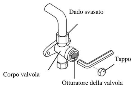
12. Utilizzando una chiave esagonale, aprire completamente sia la valvola di alta pressione che quella di bassa pressione.
